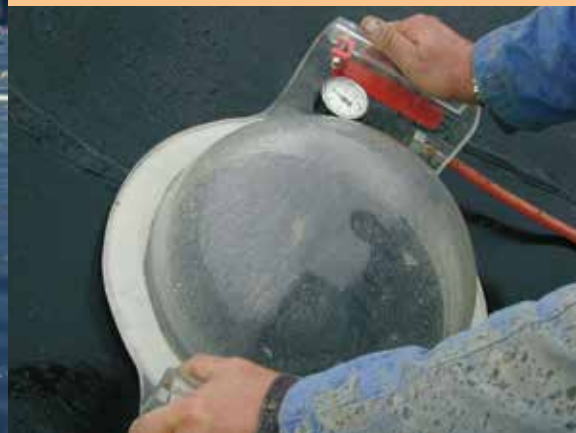
6- Controle des points singuliers à la cloche de vide
